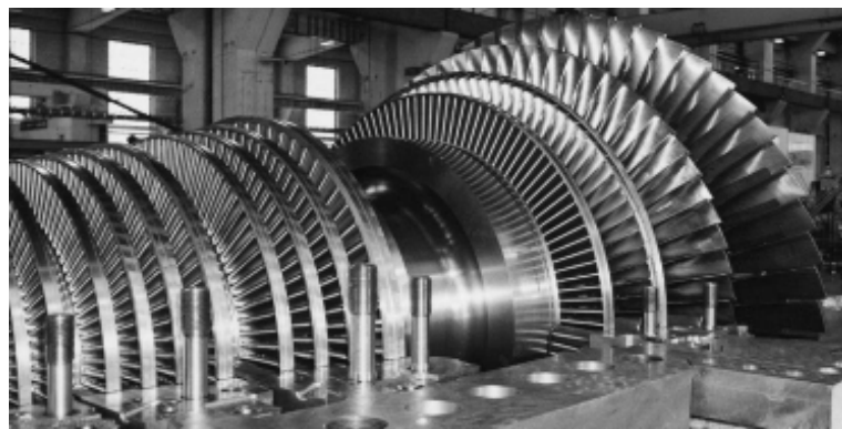
Fig. 3 Rotor de la turbina a vapor con álabes de acción y reacción
