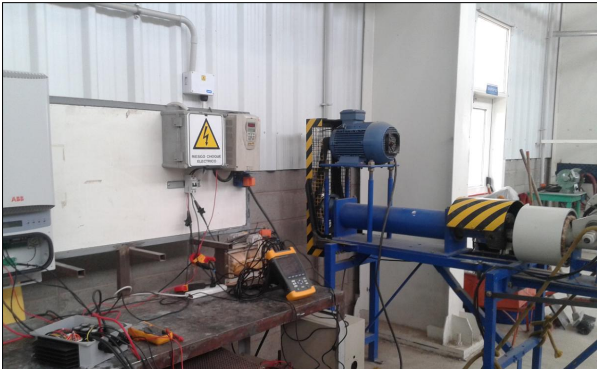
Figura 2, banco de ensayo utilizado para la obtención de las mediciones de calidad de energía inyectada a la red eléctrica de suministro.
